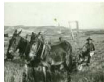
Recuerdo cuando empezaron a meterse máquinas segadoras tiradas por mulos. La máquina iba segando y con unas aspas colocando la mies para que la cortase unas cuchillas y se iba colocando en una especie de cajón. Cuando estaba lleno una de las aspas lo vaciaba en el suelo, como una gavilla, y después se ataba como cuando se segaba a mano. Quitaban mucho trabajo y se avanzaba más.
